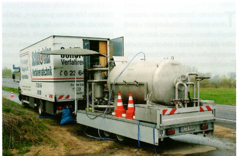
CO<sub>2</sub>-Generator zur Behandlung von Rohrnetzen.
