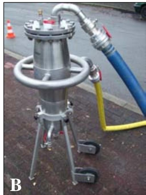
Abb. 1A. Zwei-Wege-Standrohr zur Wasserfiltration (DVGW, 1997); Abb. 1B. Filterapparatur Fabrikat Scheideler Typ 14-030, 1999.
