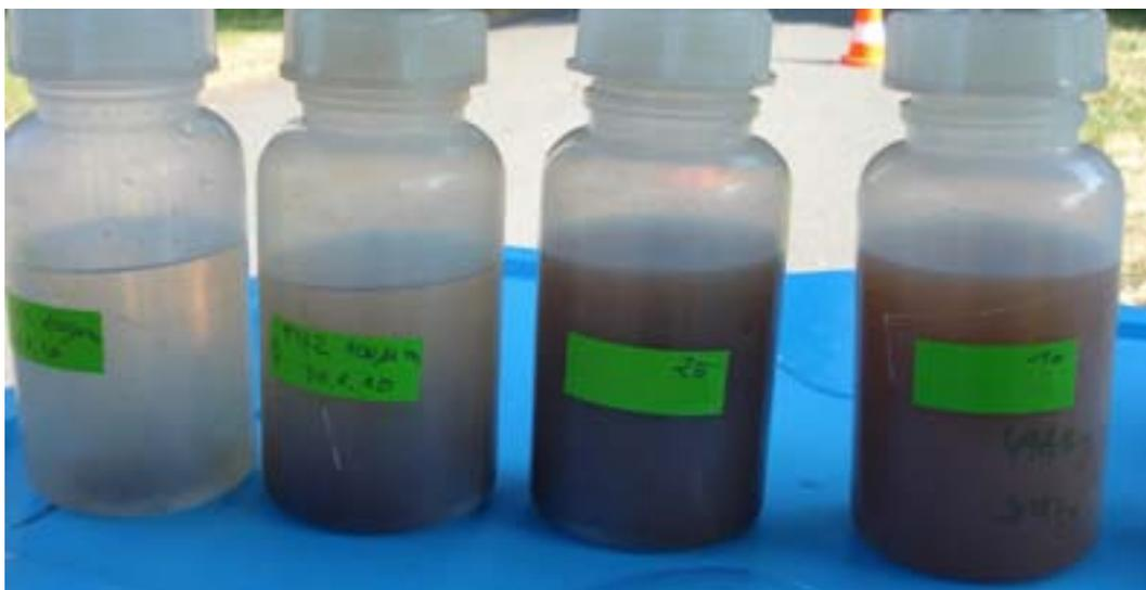
Abb. 4. Filtrerrückstände der 200 mm, 100 µm, 25 µm und 10 µm Filter bei Spülung einer Trinkwasserversorgungsleitung.
