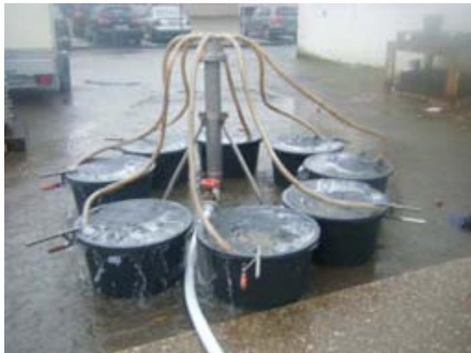
Abb. 13. Strömungsteiler mit 8 Sedimentationsgefäßen für die Probenentnahme.
