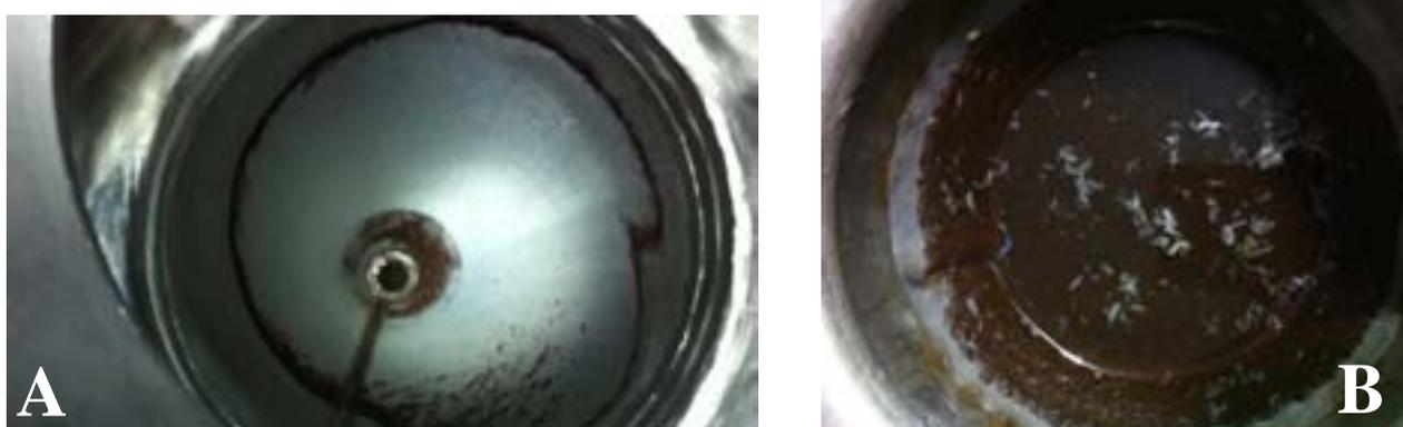
Abb. 20 A. 100 µm Filter, geringe Beladung; Abb. 20 B: 25 µm Filter, hohe Beladung.
