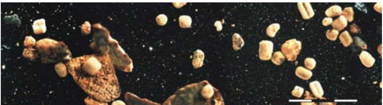
Abb. 11. Lichtmikroskopische Aufnahme von charakteristischen partikulären Ablagerungen des Filterrückstands einer Spülung, erkennbar sind Asselkot, gealterter Asselkot (gerundet) und Eiseninkrustierungen (links unten).
